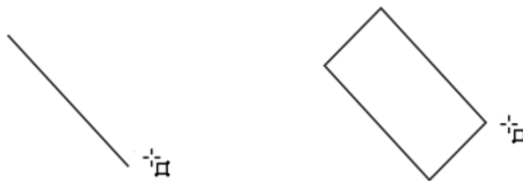
创建 3 点矩形时，可以先绘制基线，再绘制高度。产生的矩形是有角度的。
